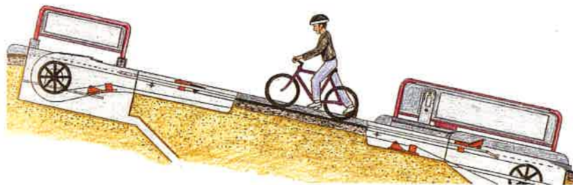
Abb. 7.12. Funktionsprinzip des Fahrradlifts Trondheim, NO (www.trampe.no, 11.08.2007)
